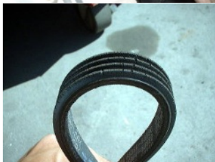
↑ ひび割れしています
